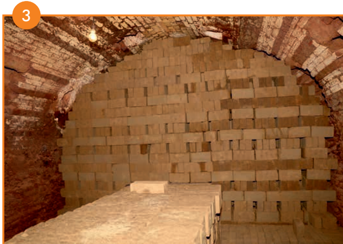
3 Une fois sèches, les briques sont placées dans le four. La briqueterie Chimot utilise un four Hoffmann (voir ci-dessous), fonctionnant au charbon et permettant au feu de se déplacer entre les briques pour une cuisson homogène.
