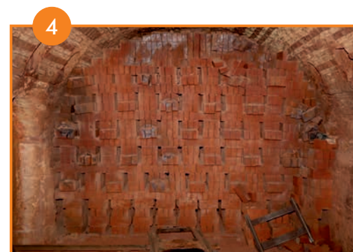
4 La cuisson, à 1 200°C, dure une semaine, pendant laquelle les briques avancent de quatre mètres par jour. Une fois cuites, elles restent dans le four une semaine supplémentaire, le temps de refroidir. Mises sur palettes et emballées, les briques terminées sont acheminées vers leurs points de vente.
