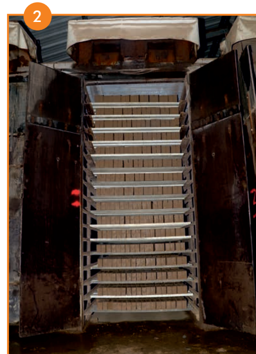
2 Les briques ainsi formées sont ensuite placées dans d'immenses séchoirs. Elles y resteront trois jours, le temps d'enlever l'humidité contenue à l'intérieur. Le séchage se fait grâce à la chaleur dégagée par le four.
