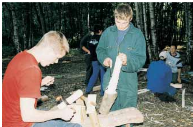
› Avec un banc d'âne, un vilebrequin, une plane et un peu d'énergie musculaire, les lycéens ont appris à transformer une bûche en maillet, à monter des bancs dépourvus de vis et de clou. Une vraie découverte !
